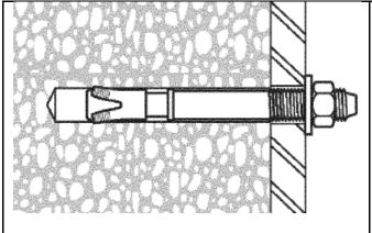
Figure 18. Stud Anchor Installation
